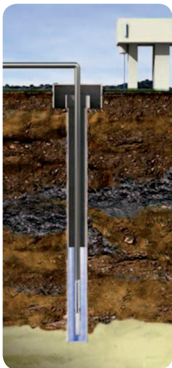
Vue en coupe d'un forage équipé d'un groupe moto-pompe immergé
