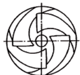
Roue hélico-centrifuge fermée à écoulement semi-axial
